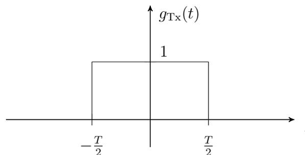
Abbildung 2: Impulsantwort des Sendefilters  $g_{\text{Tx}}(t)$ .
