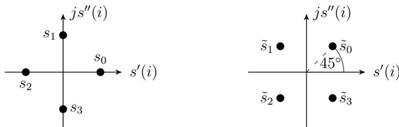
Abbildung 3: Links: QPSK-Signalraum, rechts: Gedrehter QPSK-Signalraum
