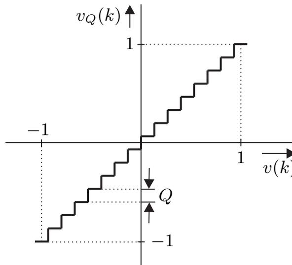
Abbildung 4: Quantisierungskennlinie
