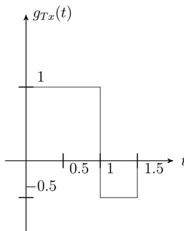
Zeichnen Sie das kausale Empfangsfilter  $g_{Rx}(t)$ , welches die Matched Filter Bedingung erfüllt.
