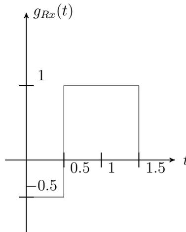
Abbildung 1: Impulsantwort  $g_{Rx}(t)$  des Empfangsfilters
