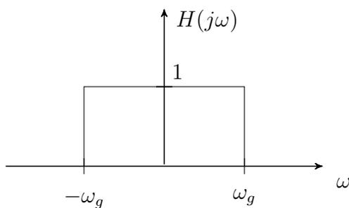
Abbildung 3: Übertragungsfunktion eines idealen Tiefpasses
