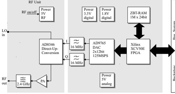
Fig. 4: Transmitter module
