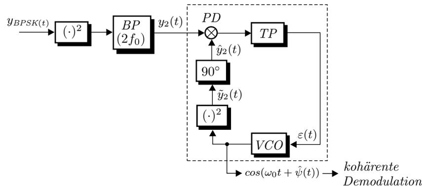
**Bild 10.3.1:** Quadrierender Regelkreis zur Trägerrückgewinnung bei Zweiseitenband-Signalen (BPSK)
