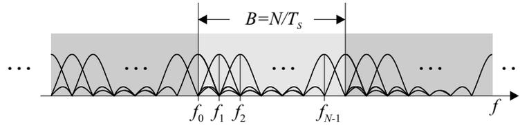
**Bild 10.2.2:** Unterträgerspektren eines OFDM-Sendesignals
