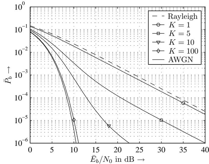
**Bild 15.2.2:** Mittlere BPSK-Bitfehlerwahrscheinlichkeiten bei Übertragung über Rice-Kanäle
